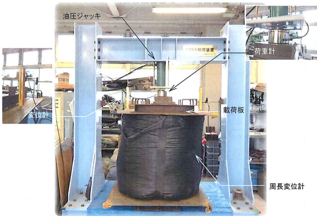
写真-3.1 圧縮試験状況
