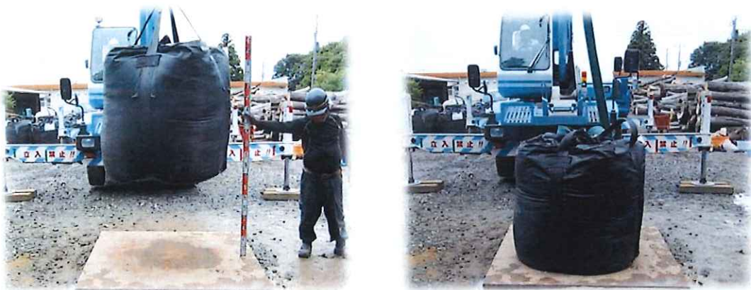
写-3.4 衝撃落下試験の状況
