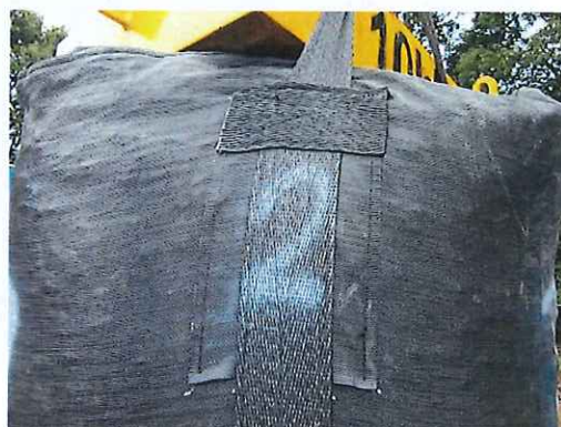
吊上げ時の本体の状況 (10kN 負荷)
