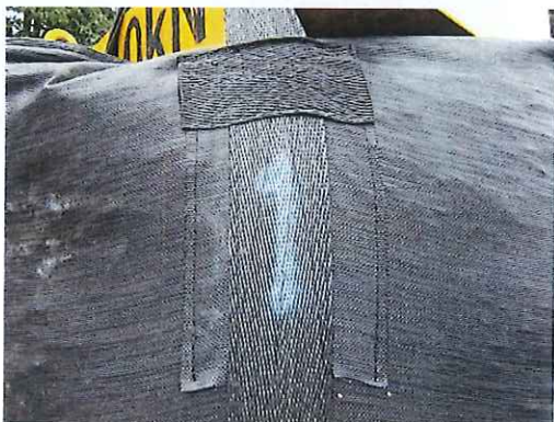
吊上げ時の本体の状況 (10kN 負荷)
