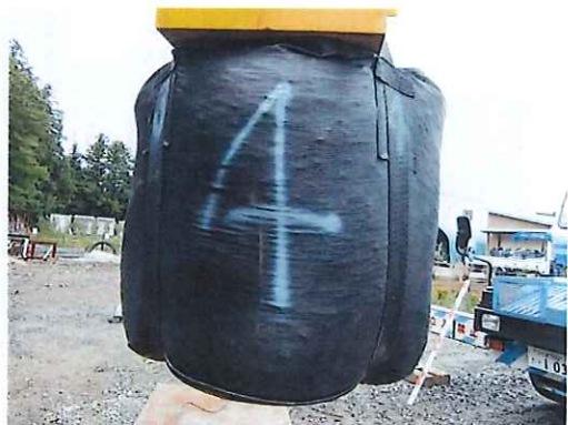
吊上げ時の本体の状況 (10kN 負荷)
