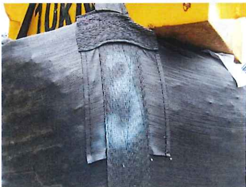
吊上げ時の吊り帯留め箇所状況 (20kN 負荷)
