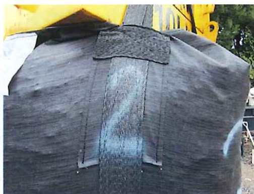
吊上げ時の本体の状況 (20kN 負荷)
