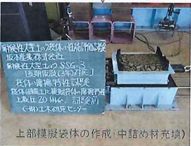
上部模擬袋体の作成(中詰め材充填)
