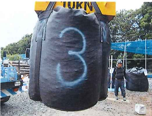
吊上げ時の本体の状況 (10kN 負荷)
