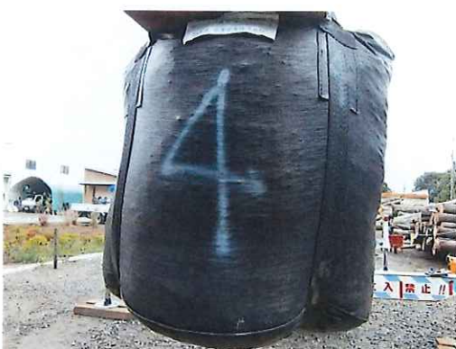
吊上げ時の本体の状況 (10kN 負荷)
