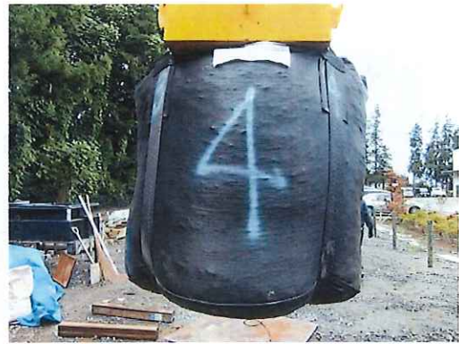
吊上げ時の本体の状況 (20kN 負荷)
