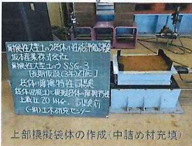
上部模擬袋体の作成(中詰め材充填)
