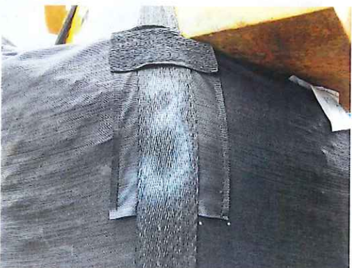
吊上げ時の吊り帯留め箇所の状況 (10kN 負荷)
