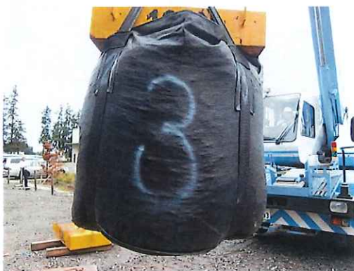
吊上げ時の本体の状況 (10kN 負荷)
