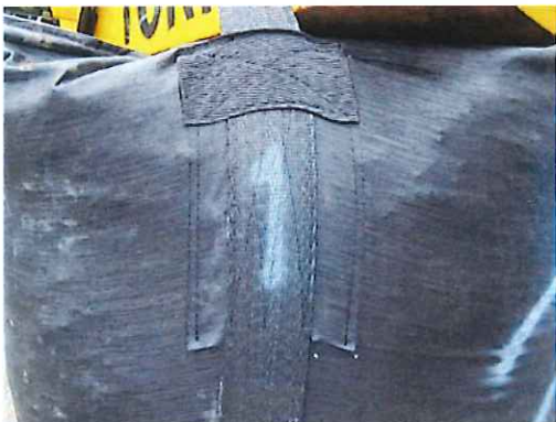
吊上げ時の本体の状況 (20kN 負荷)
