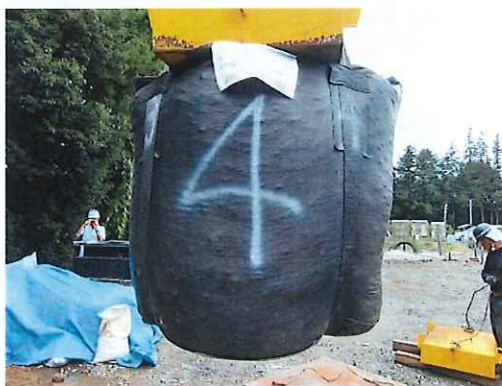
吊上げ時の本体の状況 (10kN 負荷)
