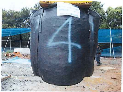
吊上げ時の本体の状況 (20kN 負荷)
