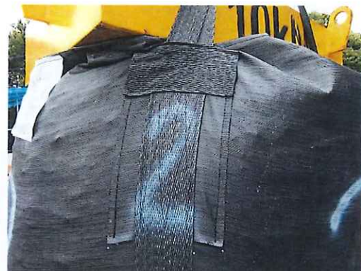
吊上げ時の本体の状況 (10kN 負荷)
