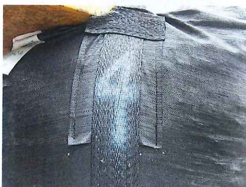
吊上げ時の吊り帯留め箇所の状況 (10kN 負荷)
