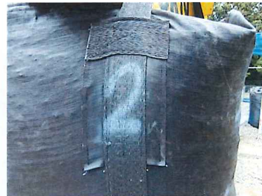
吊上げ時の本体の状況 (20kN 負荷)
