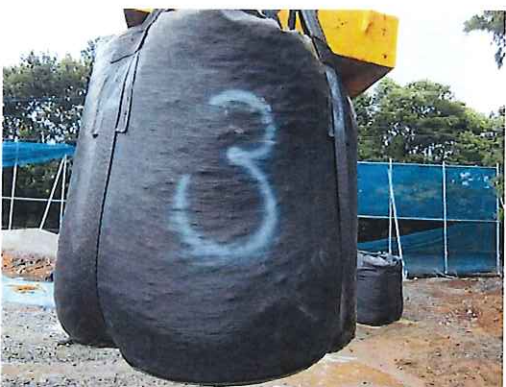
吊上げ時の本体の状況 (10kN 負荷)
